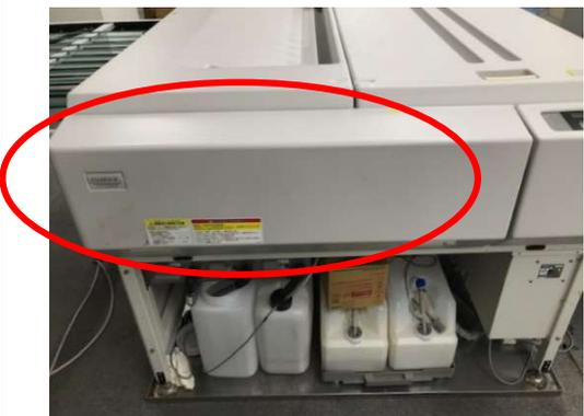
②挿入口から見て右側面のカバーを外します。
