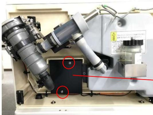
③現像フィルターケースの右側に有る黒いカバーを止めているネジを2箇所外してから、黒いカバーを外します。
